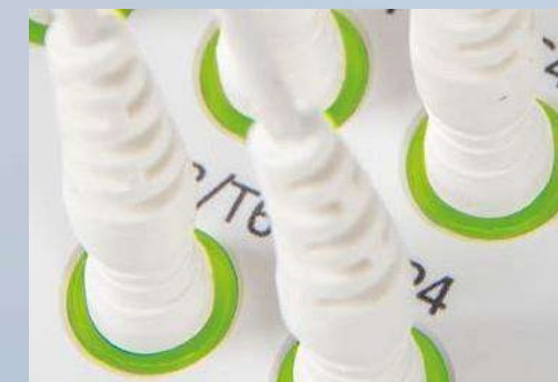
Los indicadores de impedancia codificados por color en las entradas del amplificador para monitorear la matriz de electrodos y reposicionar el electrodo rápidamente.
